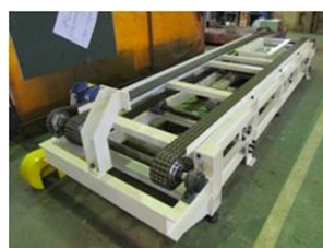
▲リフトアップ機構付パレット搬送コンベヤ
